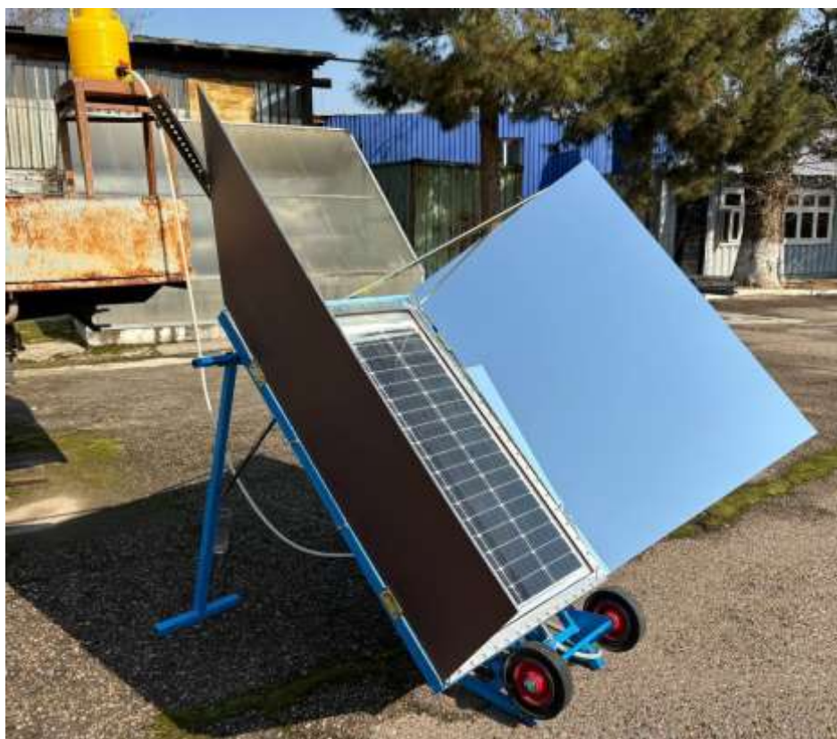
Рис. 1. Опреснительная установка получения воды из минерализованных источников с тепловым коллектором на основе структур из кристаллического кремния во время испытания в Гелиополигоне Физика-технического института (февраль 2025 г).
